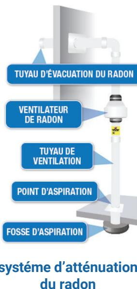
système d'atténuation du radon
